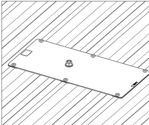
*Platine de fixation pour ligne de vie et point d'ancrage*
